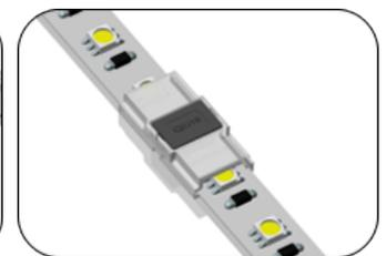
4. Drücken Sie zum Verbinden der LED-Streifen den Schließer fest nach unten. (Stellen Sie sicher, dass die Schneidkontakte die Leiterbahn der LED-Streifen durchdrungen haben und ein Durchgang der jeweiligen Polungen [+/-] besteht)
